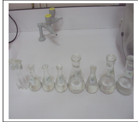
Figure C 11 : Erlen-meyer à cols rodés contenant le distillat à différents pointages de temps
