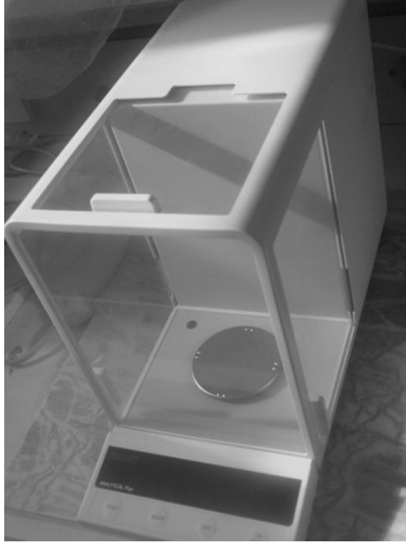
Figure 2.17 : Balance de précision utilisée dans le test d'usure
