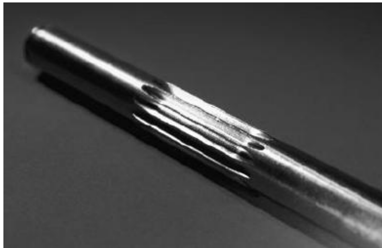
Figure 1.6 : Denture borurée d'un engrenage à fortes sollicitations
