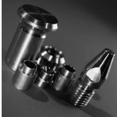
Figure 1.3 : Petites pièces en acier, borurées en vrac, puis trempées ou trempées et revenues selon l'alliage.
