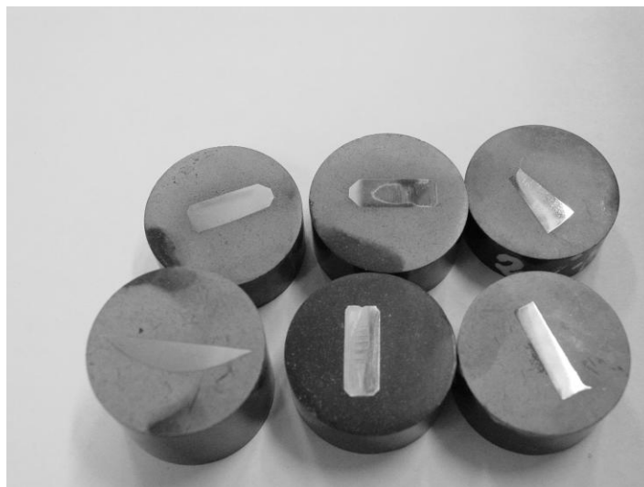
Figure 2.7 : Quelques échantillons enrobés
