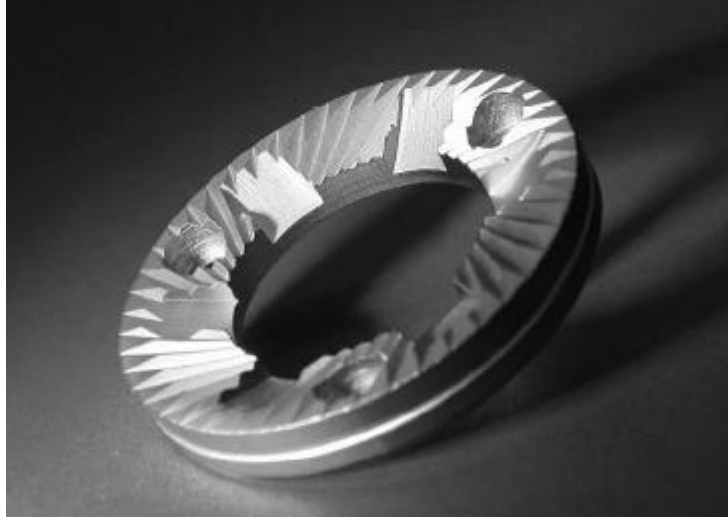
Figure 1.5 : Disque de broyeur en acier de cémentation cémenté, boruré et trempé utilisé en industrie alimentaire
