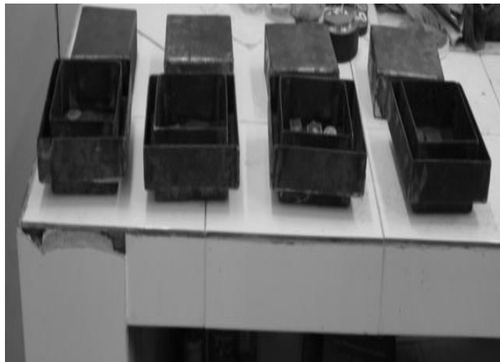
Figure 2.3 : les caisses ouvertes utilisées pour la borocarbonituration
