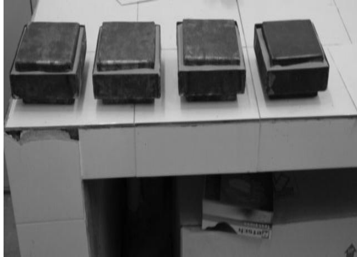
Figure 2.2 : les caisses fermées utilisées pour la borocarbonituration
