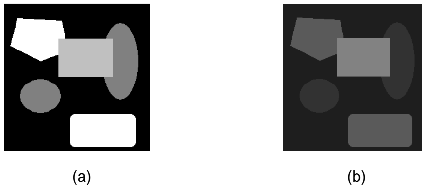
Figure 3.6: Segmentation par le mean-shift ( hs=7 , hr=8 ), (a) «Image originale à 6 régions parfaitement uniformes», (b) « Image segmentée »
