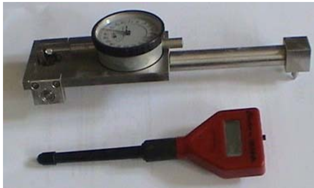
Figure 2.26 : Appareil pour mesurer l'expansion des mortiers
