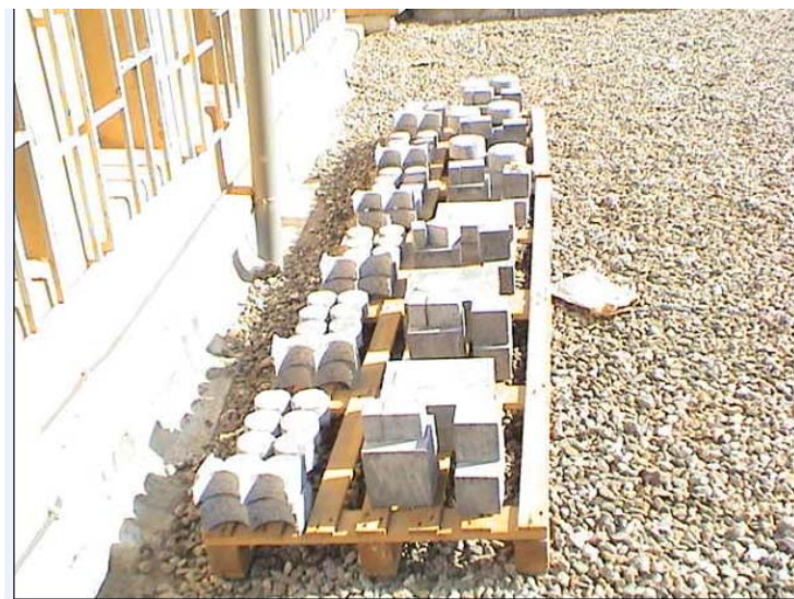
Figure 2.11: Echantillons à l'air libre (atmosphère non contrôlée) après une cure initiale de 7 jours dans l'eau
