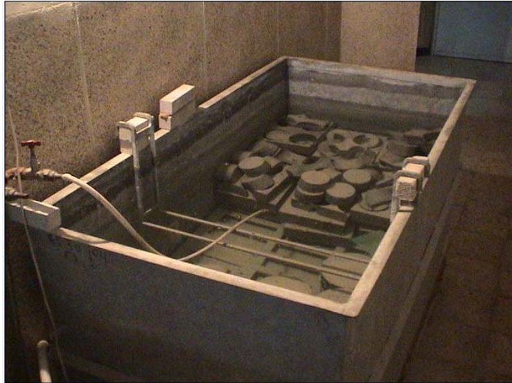
Figure 2.10 : Epreuves conservées dans l'eau (cure humide)
