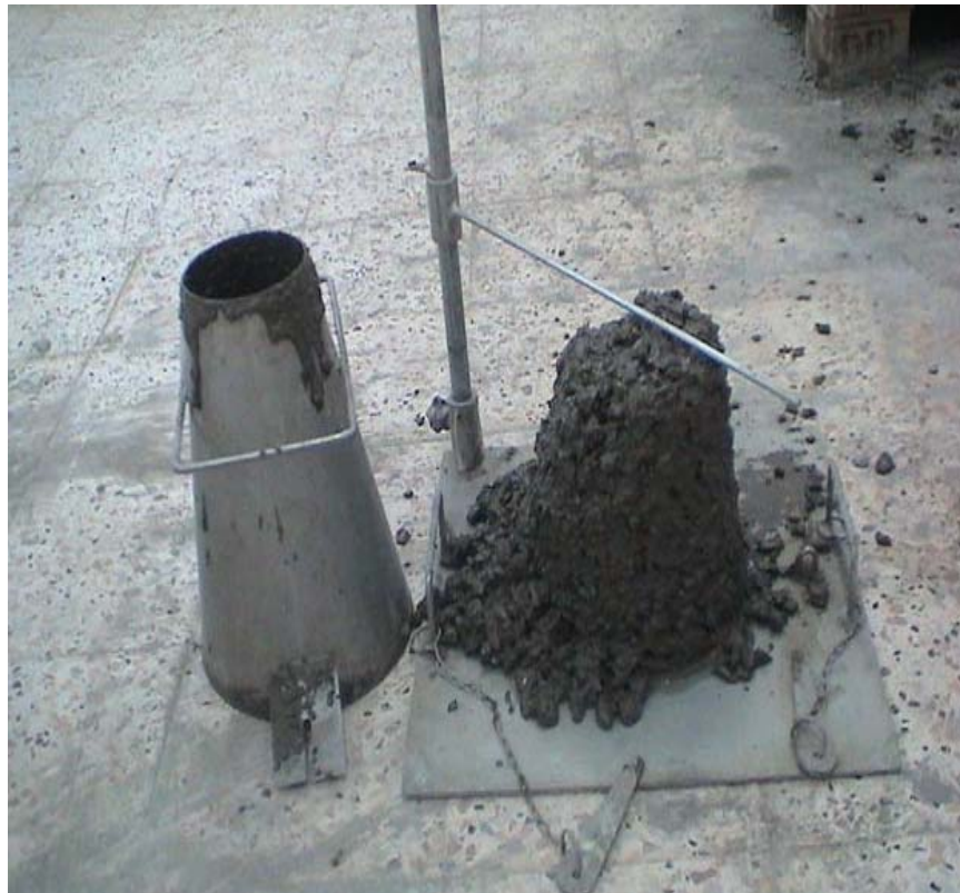
Figure 2.12 : Essai d'affaissement (cône d'Abrams)
