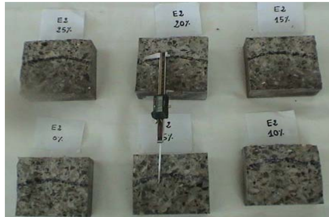
Figure 2.18 : Mesure la profondeur de pénétration de l'eau
