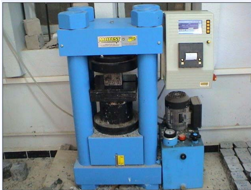
Figure 2.13 : Dispositif de l'essai de compression simple
