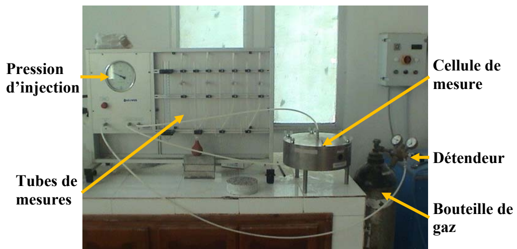
Figure 2.21: Perméamètre au gaz de CEMBUREAU
