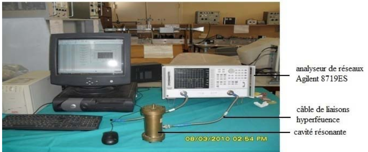
Figure 4.6 : Appareillage de mesure des propriétés diélectrique.
