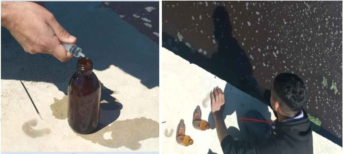
Figure 2.2 : Prélèvements et Stabilisation des échantillons par l'acide chlorhydrique pour l'analyse des métaux.
