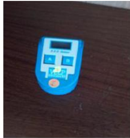
Figure 2.6 : Dispositif de mesure de la DBO 5 .
