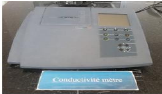
Figure 2.4 : Conductivité-mètre de paillasse utilisé pour l'analyse.
