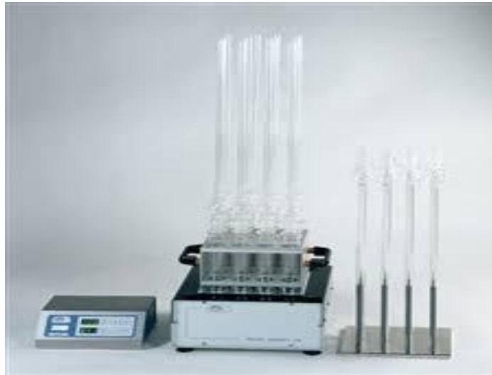
Figure 2.5 : Dispositif de mesure de la demande chimique en oxygène (DCO).
