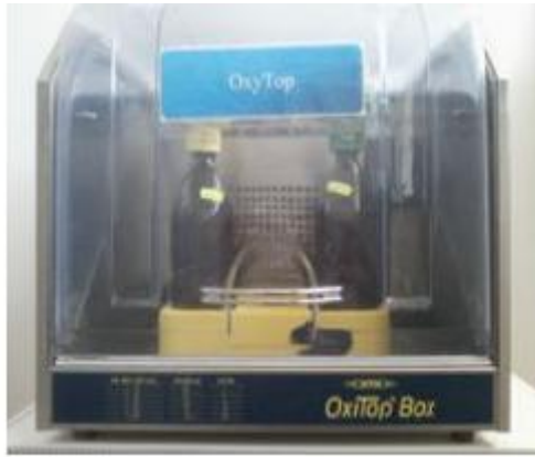
Figure 2.6 : Dispositif de mesure de la DBO 5 .
