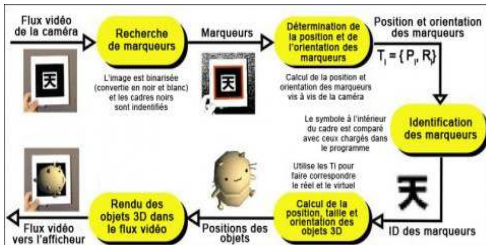
Figure 38 : Schéma de principe d'ARToolKit
