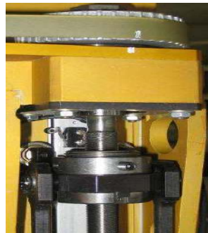
Figure 12 : capteur de fin de secoure dans un articulateur d'un robot bipède PID
