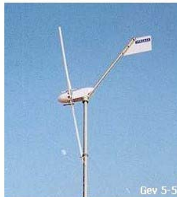
Figure G.6.1 : Aérogénérateur VERGNET GEV 5/5
