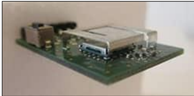
Figure II.11 : L'utilisation d'une antenne PIFA
