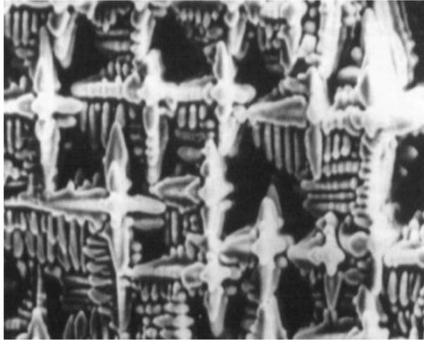
**Figure II-17:** Cavité dans une pièce solidifiée tapissés de dendrites. [11].
