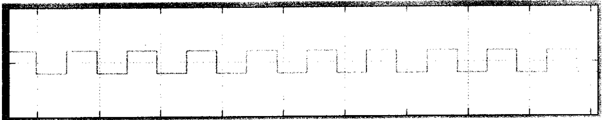
Figure III-16-a : signal rectangulaire de la modulation BOC avec n pair
