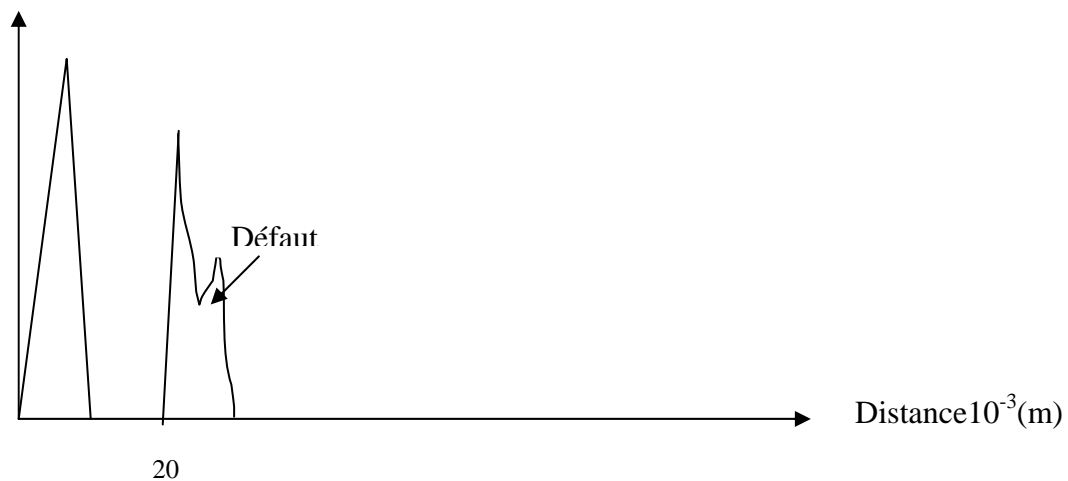
Figure 5.28 : Contrôle de la pièce n° 6 par un palpeur droit
