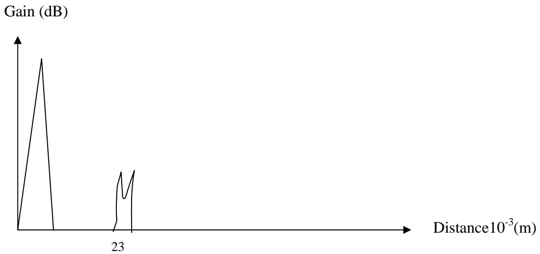
Figure 5.26 : Contrôle de la pièce n° 6 par un palpeur droit
