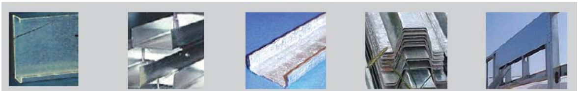
Figure 1.1 : Fabrication des Profilés à base de plat d'acier galvanisé de faible épaisseur.
