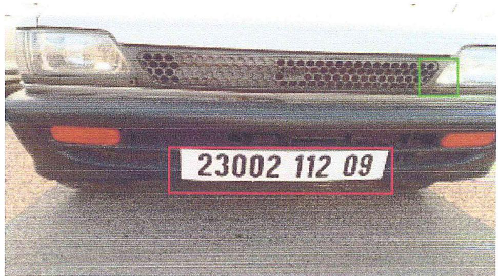
Figure 107 : Détection de la plaque
