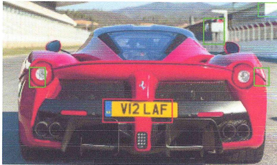
Figure 95 : Détection de la plaque
