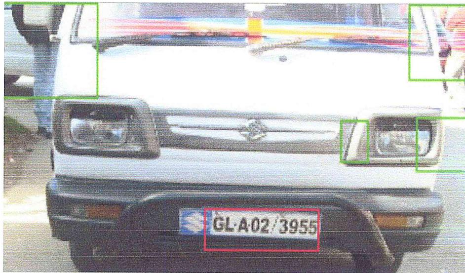
Figure 101 : Détection de la plaque
