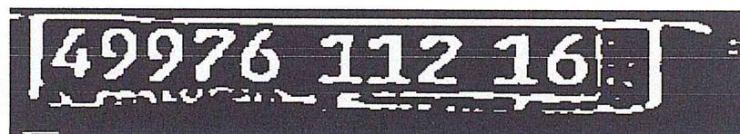
Figure 89 : Image de la plaque d'immatriculation résultante des opérations morphologiques
