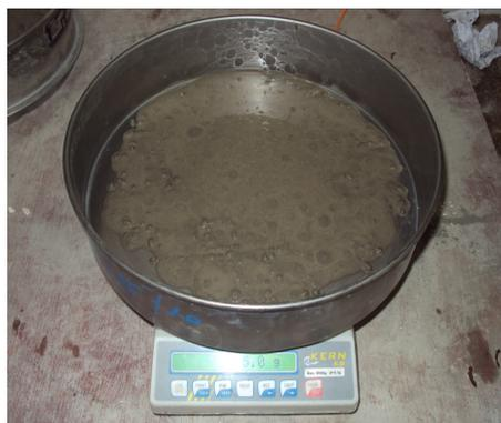
Figure 2.13 – Mesure de la laitance du BAP par l’essai de stabilité au tamis
