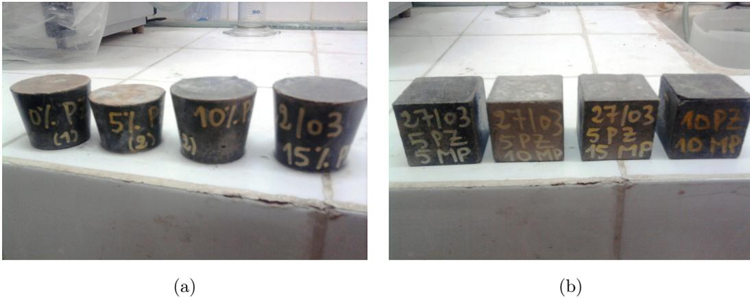
FIGURE 5.14 – Examen visuel des échantillons exposé à 5% de  $\text{Na}_2\text{SO}_4$  après 8 mois : (a) Mortier binaire - (b) Mortier ternaire
