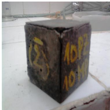
FIGURE 5.15 – Examen visuel de mortier ternaire contenant 10%PZ+10%MP exposé à 5% de  $\text{Na}_2\text{SO}_4$
