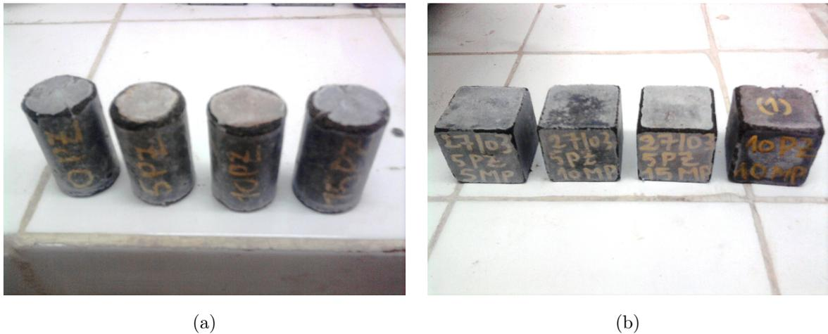
FIGURE 5.6 – Examen visuel des éprouvettes pour : (a) Mortier binaire; (b) Mortier ternaire exposé à 5% de  $MgSO_4$  après 8 mois
