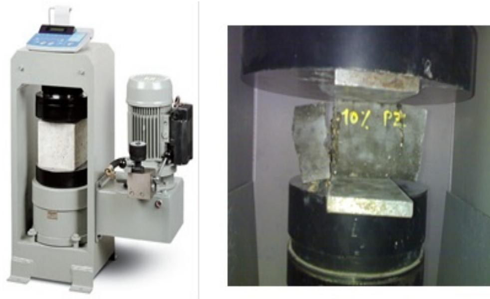
Figure 2.15 – Machine d'écrasement pour l'essai de la résistance au compression
