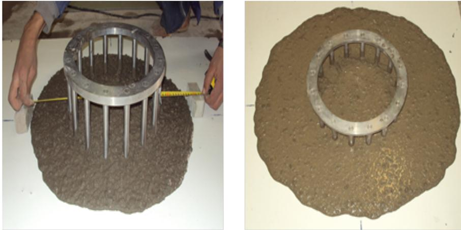
Figure 2.9 – Mesure d'étalement en présence du J-Ring
