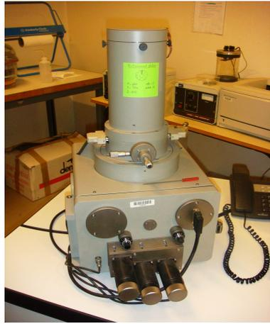
Figure 4.3 – Microscope électronique à balayage
