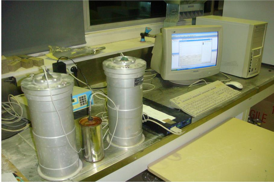
Figure 2.14 – Dispositif expérimental pour la mesure de la Chaleur d'Hydratation
