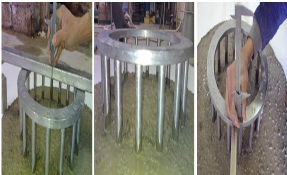
Figure 2.10 – Mesure des hauteurs à l'intérieur et à l'extérieur du J-Ring
