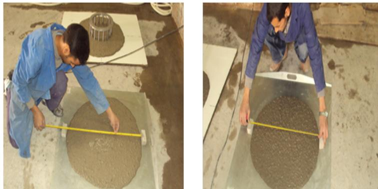
Figure 2.6 – Mesure du diamètre d'étalement
