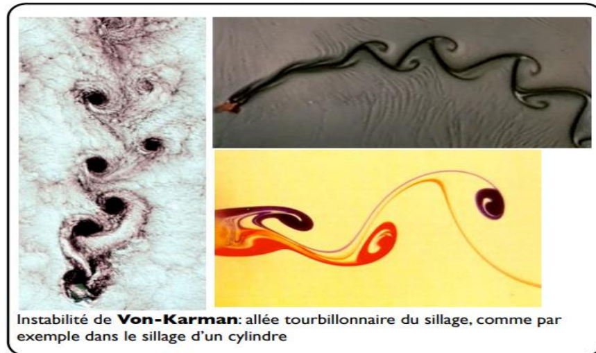
Figure III.3 : instabilité de Von-Karman
