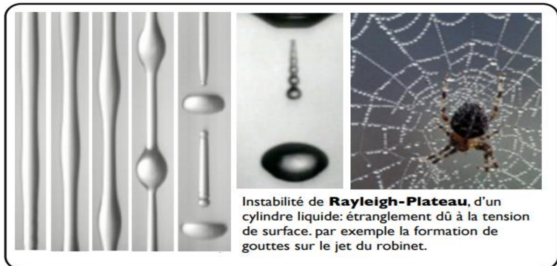
Figure III.2 : instabilité de Rayleigh-Plateau
