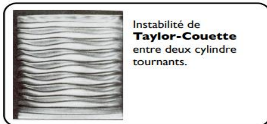
Figure III.5 : Instabilité de Taylor-couette
