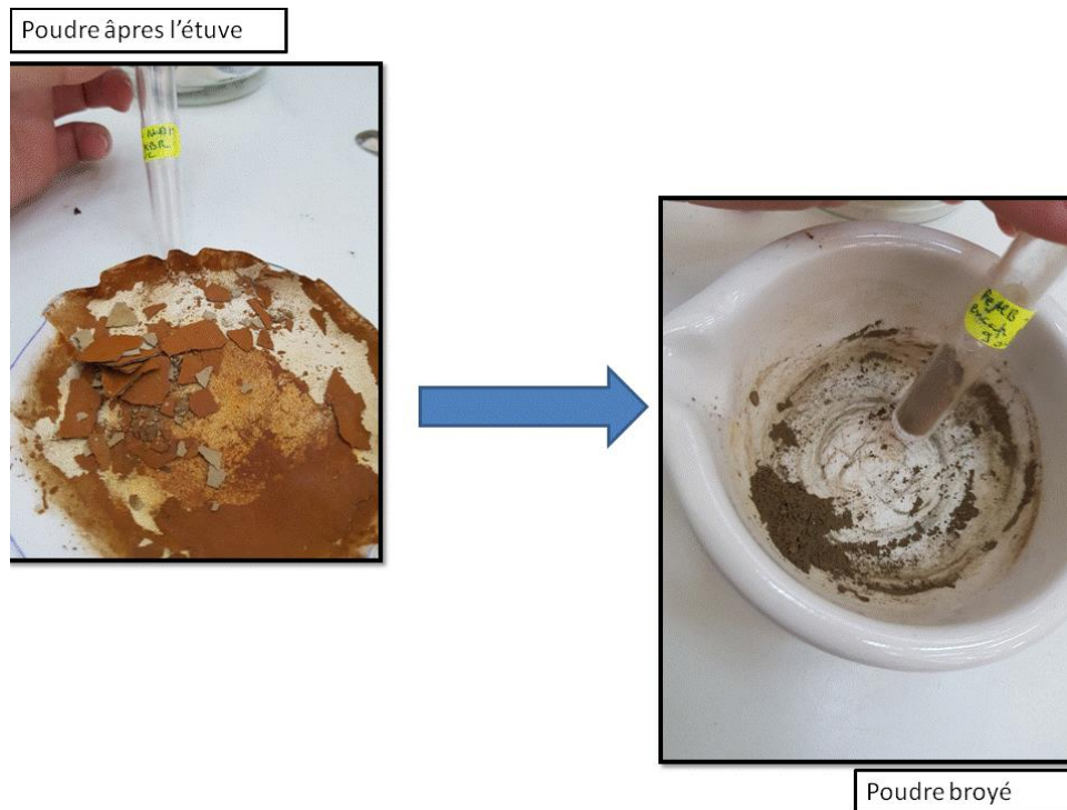
Figure 3.18 : Echantillon \text{Fe}_2\text{AlB}_2 après l'étuve.
