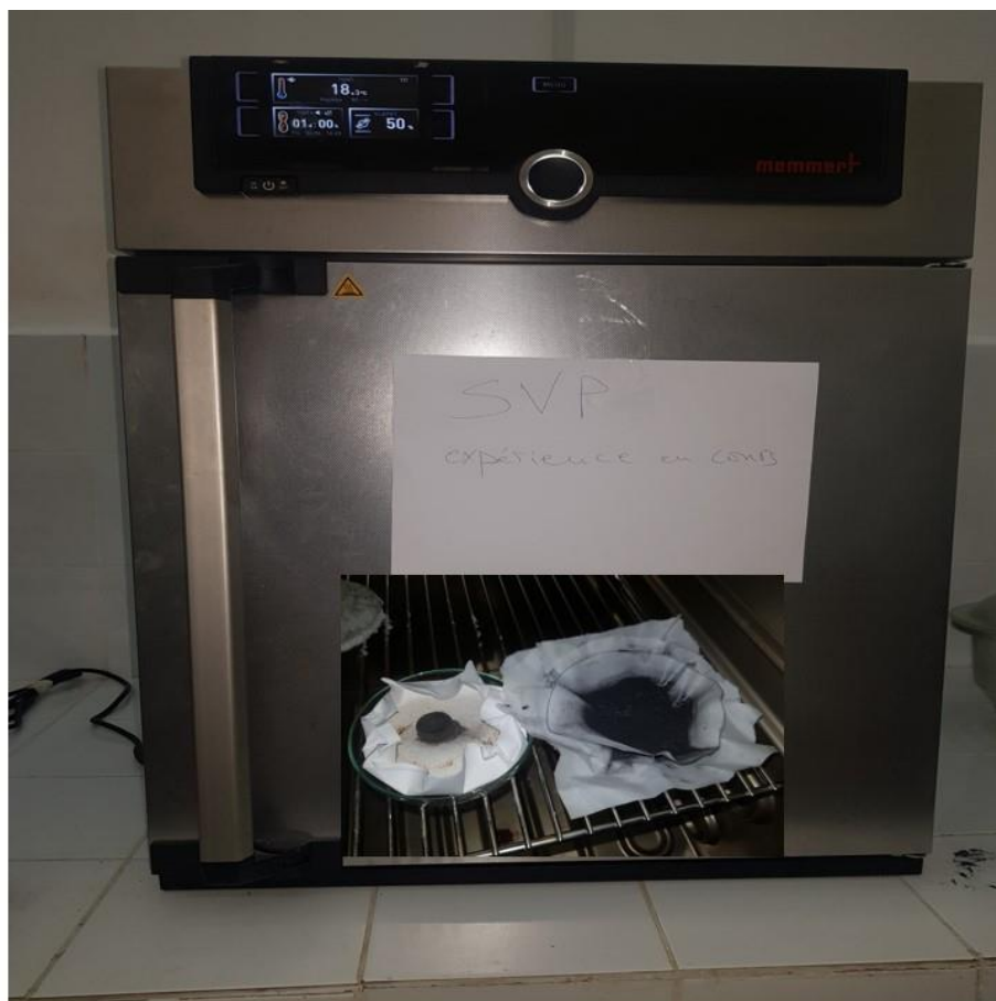
Figure 3.17 : les échantillons filtrés dans l'étuve MEMMERT
