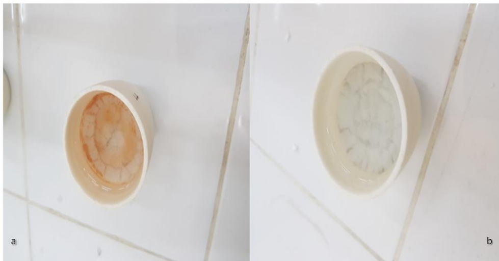
Figure 4.1 : les échantillons après 3h30 dans le four et un temps de maintien de 1h a)avec le NaBr b) avec le KBr .
