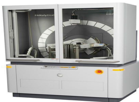
Figure 3.18 : Diffractomètre de Rayons X, PanalyticalX'pert Pro, D8, CRTI, Chéraga.
