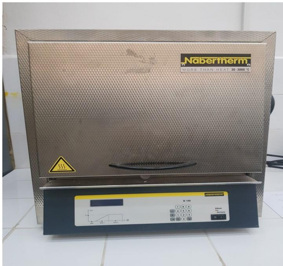
Figure 3.13 :un four à moufle (NABERTHERM B180).
