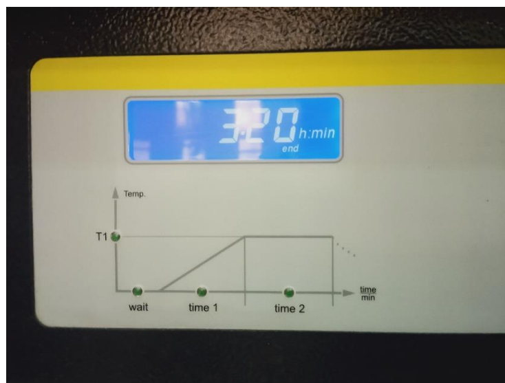
Figure 3.12 :afficheur de réglage de la température de fur
