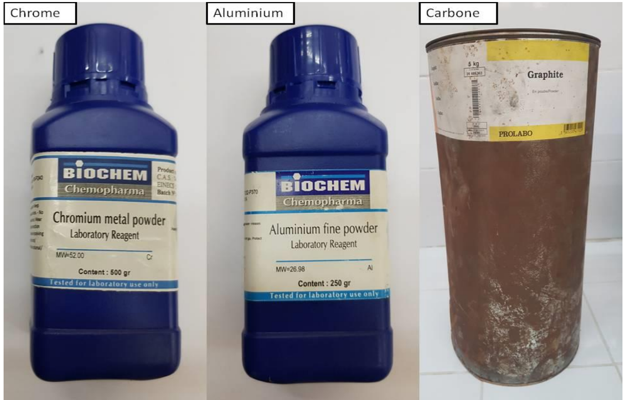
Figure 3. 1 : Poudres utilisées pour la synthèse du \text{Cr}_2\text{AlC} .
