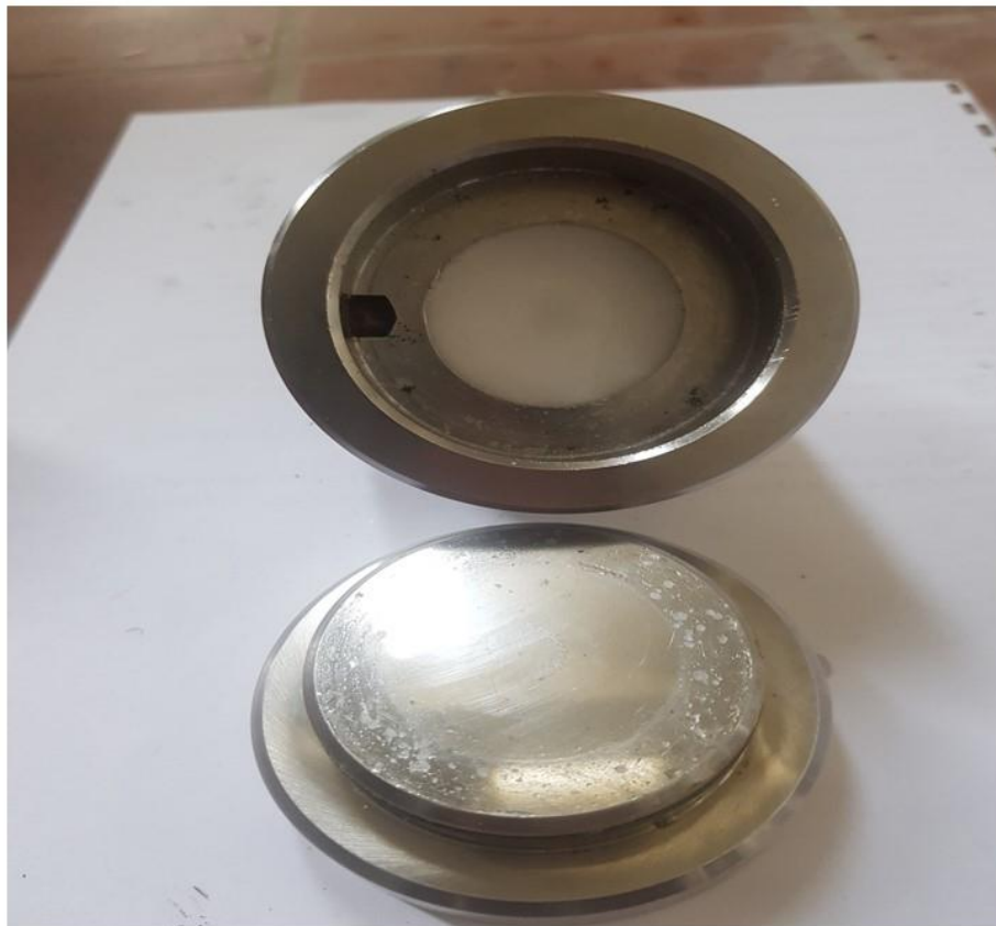
Figure 3.9 : montre la pastille entourée par le sel KBr
