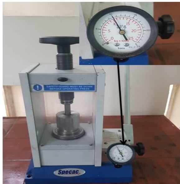
Figure 3.8 : Pastilleuse de laboratoire SPECAC, capacité maximale 25 tonnes.
