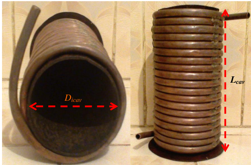
Fig.5.5 : Vue représentative des enroulements en tube de cuivre posés sur la cavité cylindrique.
