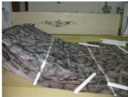
Figure I.20 - Navigation par suivi de terrain par flux optique
