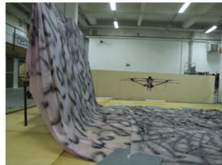
Figure I.20 - Navigation par suivi de terrain par flux optique
