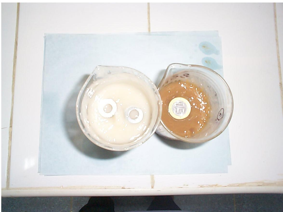
**Fig.VI.B.8 : Exhibition de la capacité de mise en suspension de la boue AO + gasoil avant et après vieillissement à 250 °F**
