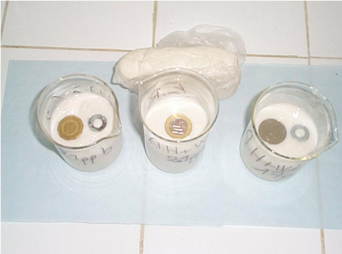
**Fig.VI.B.51: Exhibition de la capacité de mise en suspension de la boue AHM + eau**
