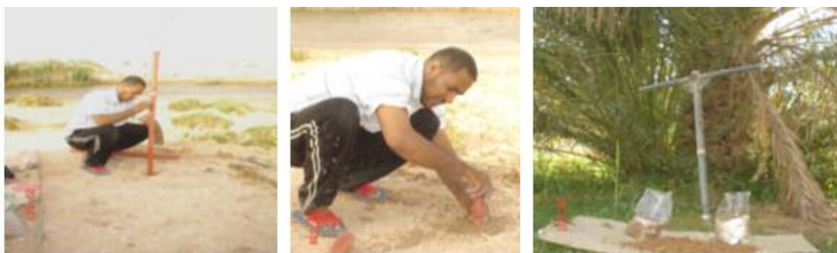
Photos 4.1 : Implantation des piézomètres de surveillance et prélèvement des échantillons du sol., 2008.
