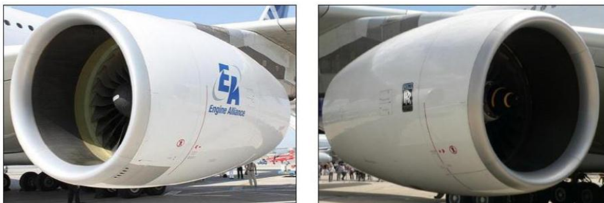
FIGURE 1. 8: GP 7200- REACTEUR D'ENGIN ALLIANCE / TRENT 900- REACTEUR DE ROLLS-ROYCE.
