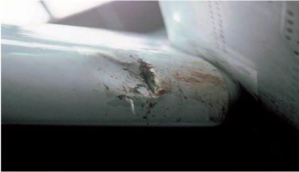
FIGURE 3. 1: Bord d'attaque endommagé
