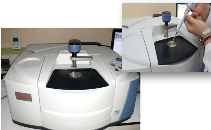
**Figure II.1** : Appareil d'analyse ATR-FTIR
