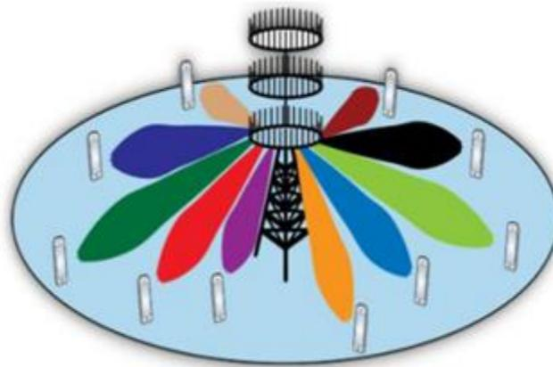
**Figure 1.4** Système massive MIMO avec  $N$  antennes pour desservir  $K$  utilisateur [12]
