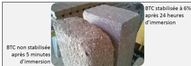
Figure108: différence entre un BTC stabilisée et non stabilisée
