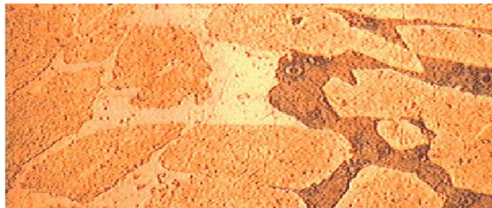
Figure 7: Coupe métallographique montrant une corrosion sélective d'un laiton [15]
