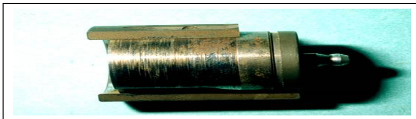
Figure 9: Corrosion frottement d'une pièce en acier [17]
