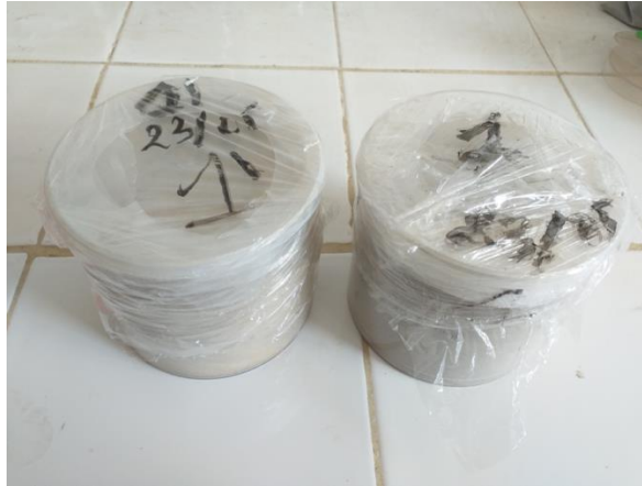
Figure 4.2 : Echantillons conservés dans des Marinellis et scellés par un film de paraffine.
