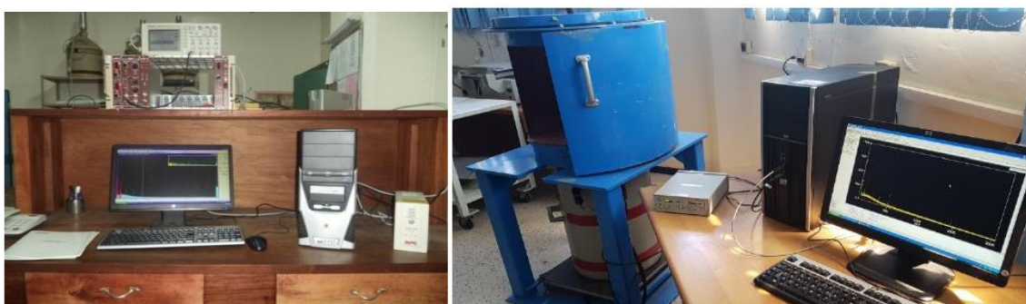
Figure 3.9 : Chaîne de spectrométrie gamma au CRND utilisée dans le présent travail.
