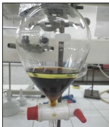
Figure 4.7 : Décantation (extraction liquide-liquide)
