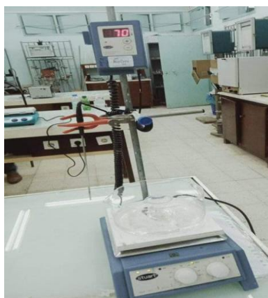
Figure II.1 : Montage expérimental Pour la préparation de l'acide
