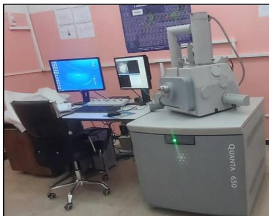
**Figure 2.2 :** Appareil de Microscopie électronique à balayage (MEB)
