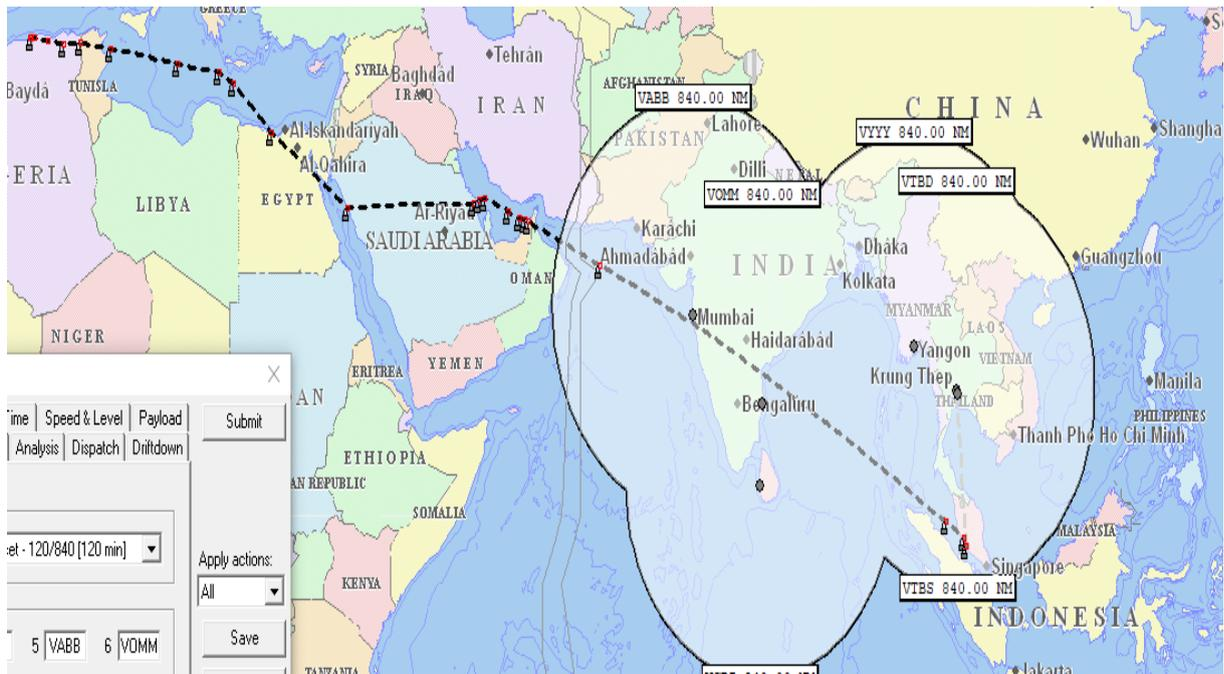
Figure.III.5. de la zone ETOPS 120 min
