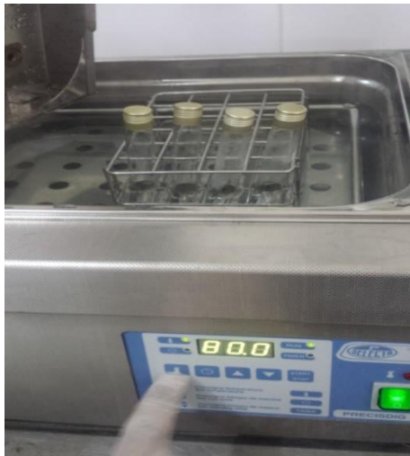
3. Chauffage à 80°C/10 minutes robinet
