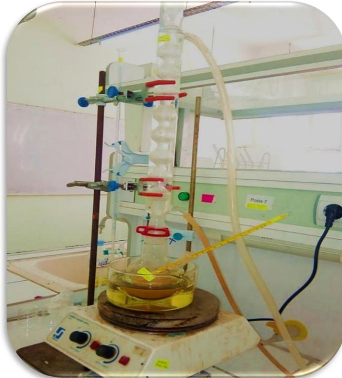
Figure 2. 2 : Extraction de la pectine sous reflux.
