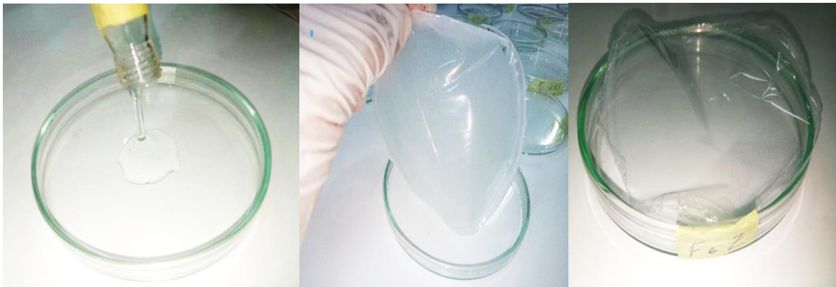
Figure II.2 : représentant la préparation d'un film HPMC
