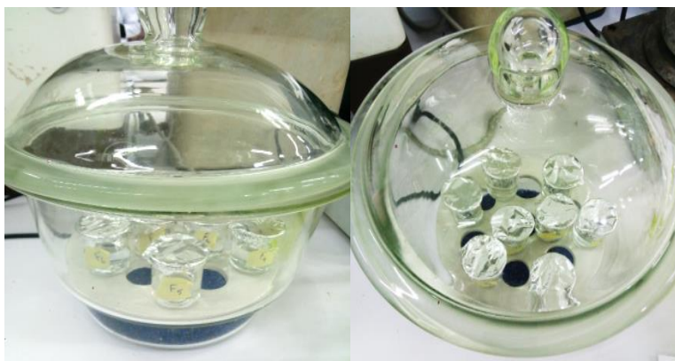
Figure II.3 : la préparation des échantillons dans dessiccateur
