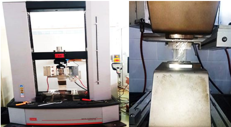
Figure II.8 : Machine de L'essai de traction INSTRON
