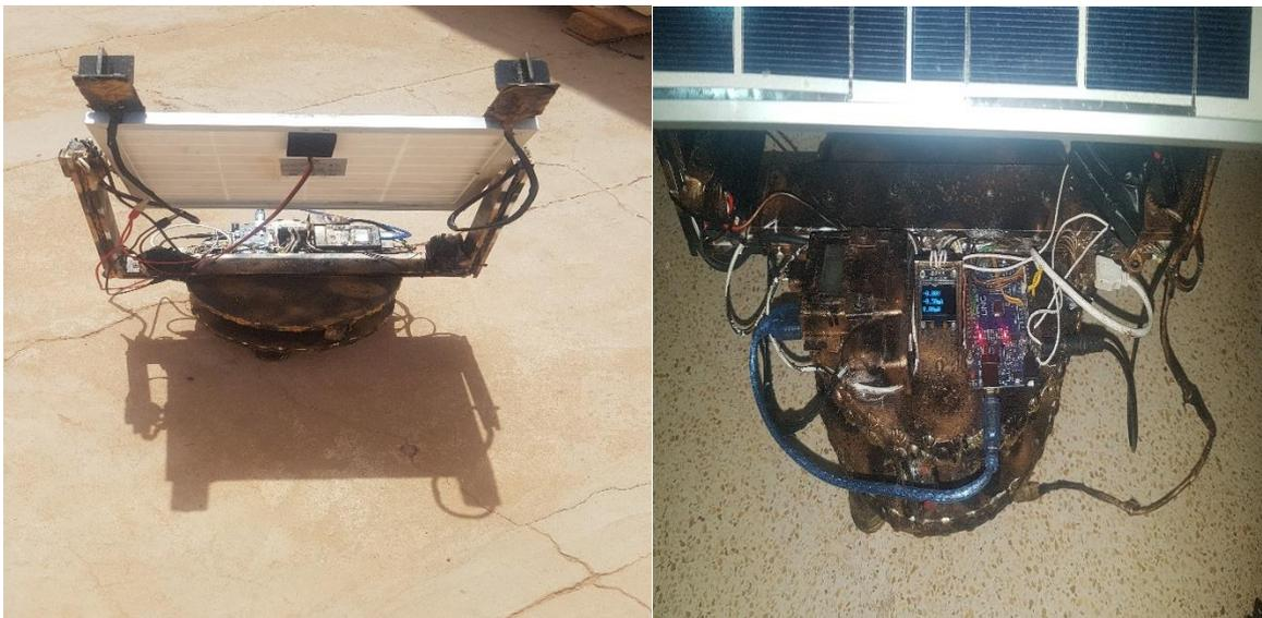
Figure.III.13 Le montage real de poursuiveur solaire
