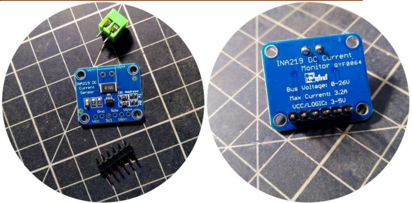
Figure.III.7 capteur de courant ina219
