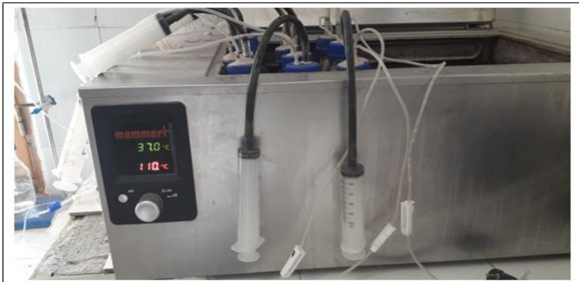
Photo III. 9: Les réacteurs dans un bain marie chauffé et régulé à 37°C (milieu aérobie).
