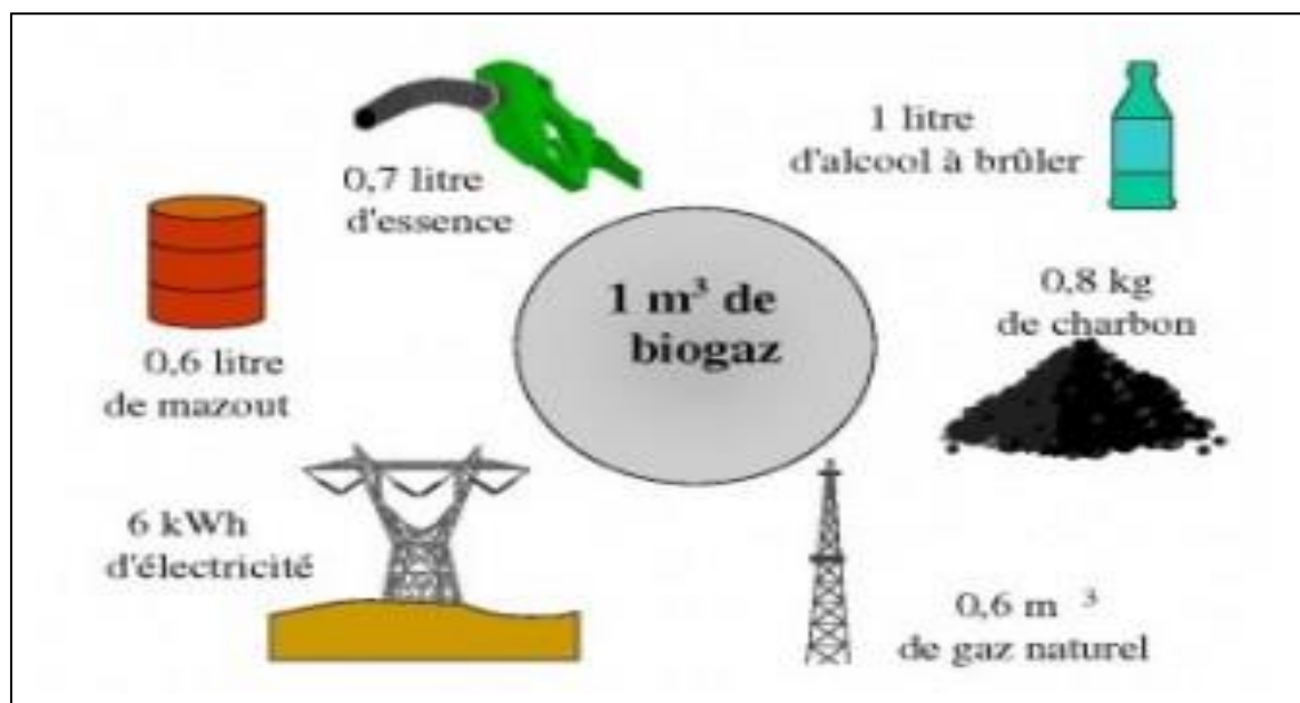
Figure II.5 : Equivalence énergétique du biogaz
