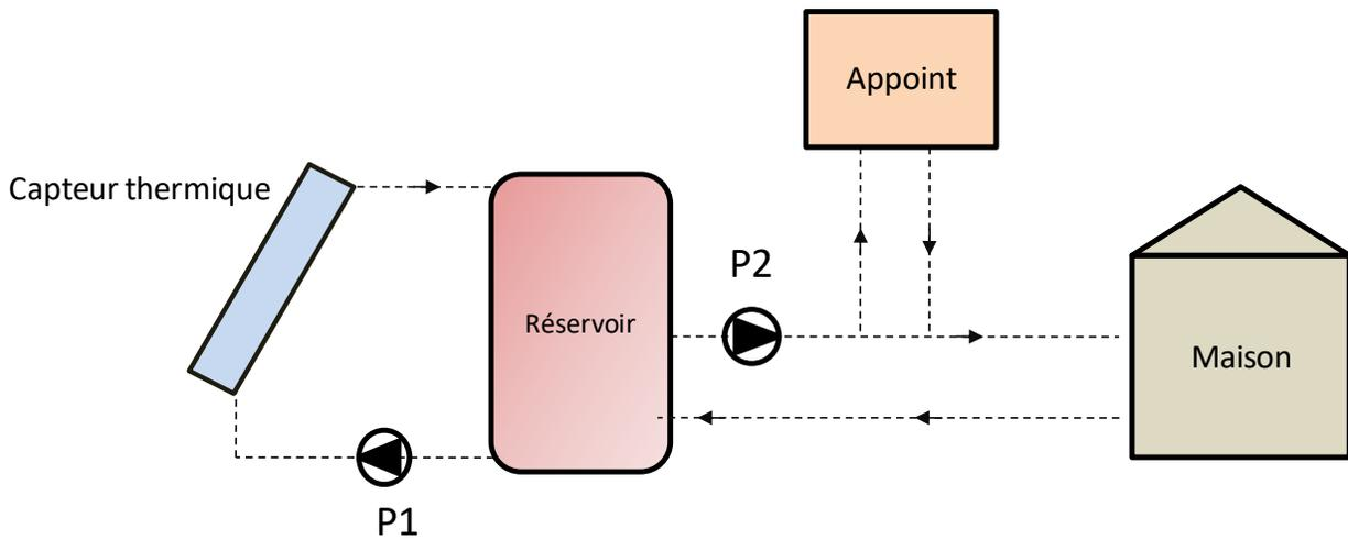
*Figure 2.01 Schémas du système de chauffage solaire étudié*
