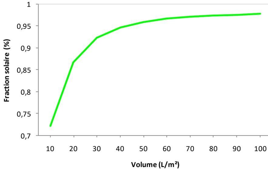
*Figure 4.08 Influence du volume du réservoir de stockage*
