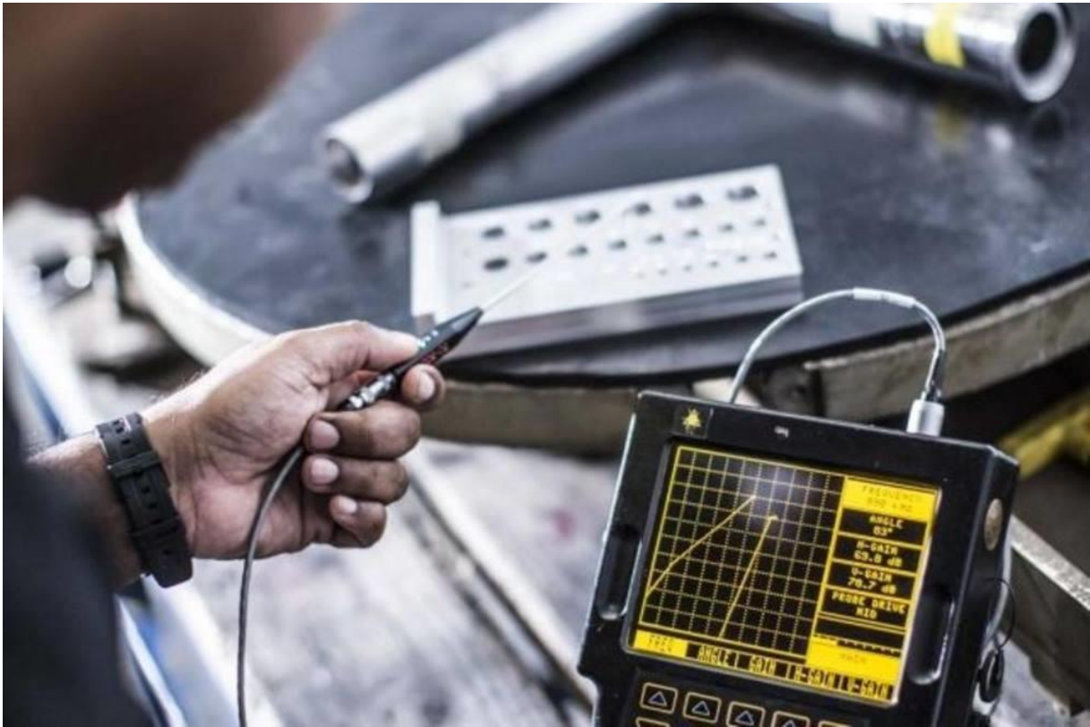
Figure II.9: Mesure par courants de Foucault sur une pièce industrielle [43].
