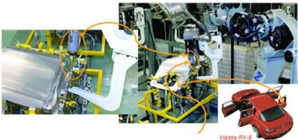
Figure I.22: Soudage « friction-malaxage » par point utilisé pour l'automobile [31].
