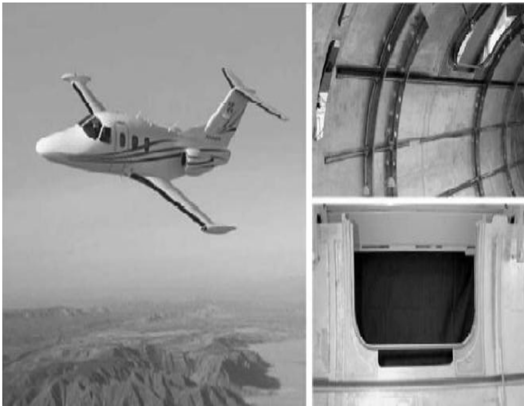
Figure 0L19: Assemblage de l'avion Eclipse avec le procédé de FSW [7].
