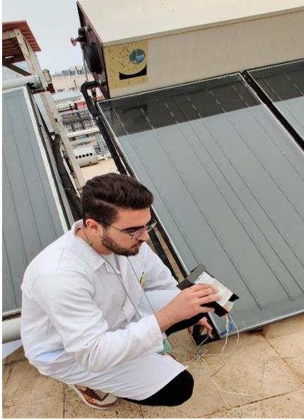
*Figure III- 3: mesure de la température à l'entrée du capteur.*
