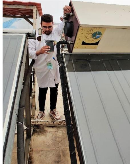
*Figure III- 6: mesure de la température à la sortie de la cuve de stockage.*
