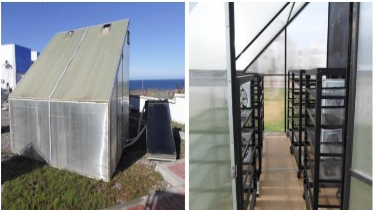
Figure I- 2: Séchoir solaire mixte de l'intérieur et de l'extérieur [5].
