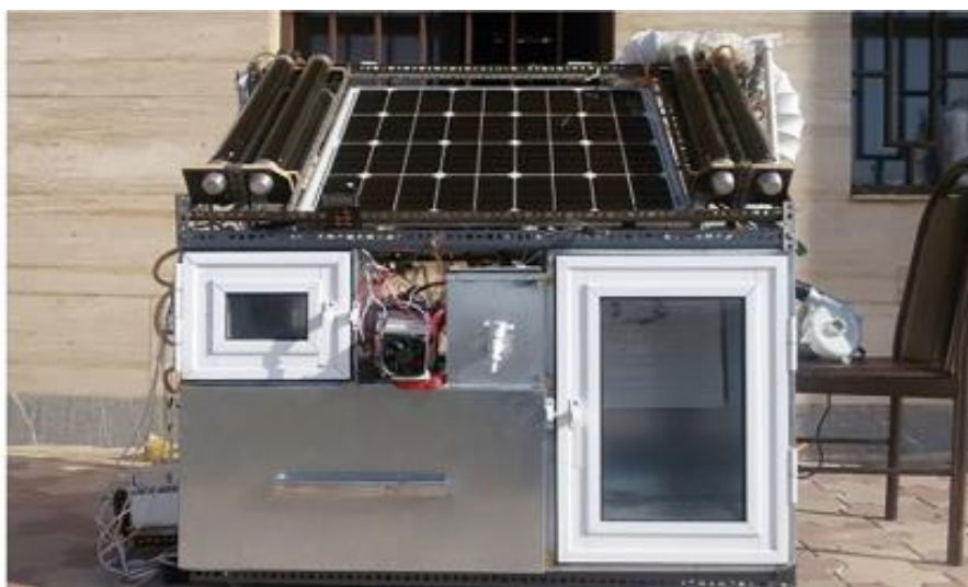
Figure I- 9: Vue d'ensemble du séchoir fabriqué [10]
