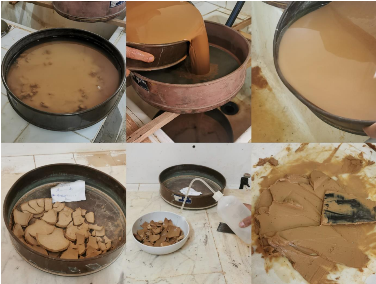
Figure 18 : Préparation de l'échantillon pour la limite l'Atterberg.
