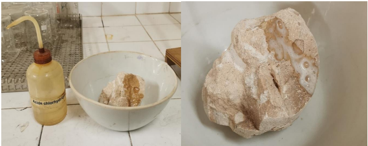
Figure 15 : La réaction de HCL avec une roche sédimentaire.
