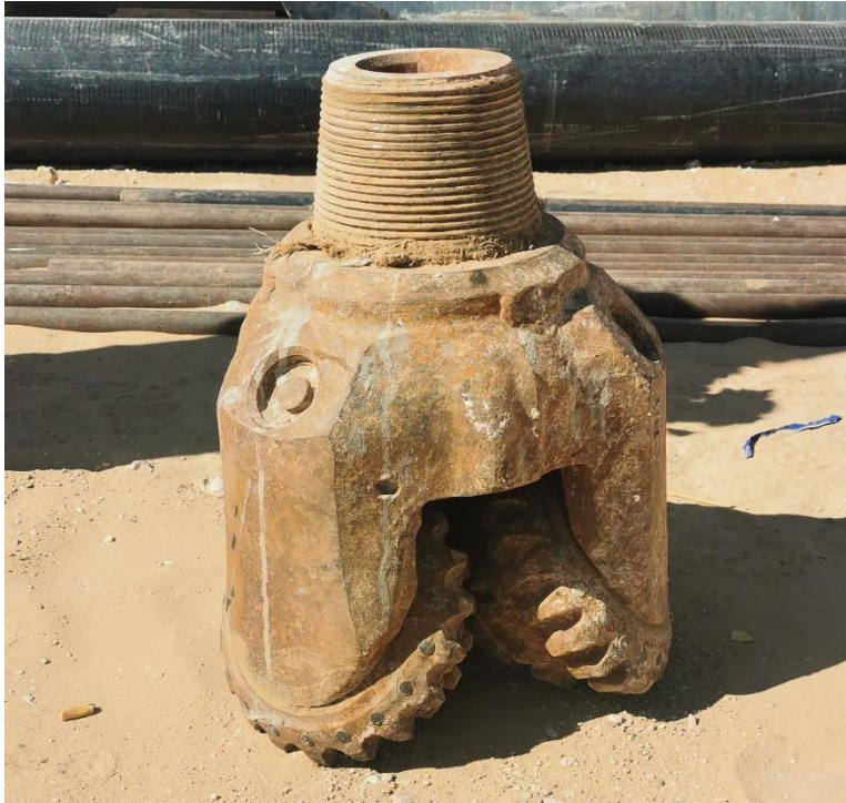
Figure 03 : Un tricône (l'outil de forage).
