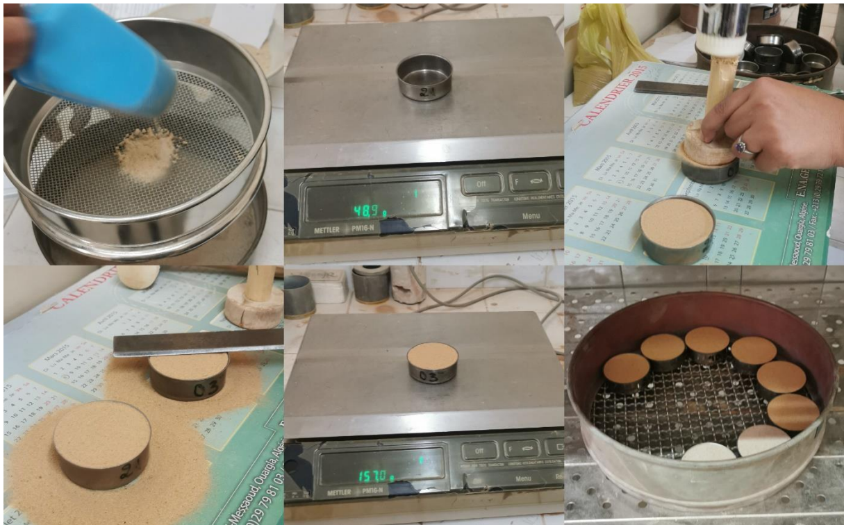
Figure 17 : Essai de poids spécifique et teneur en eau.
