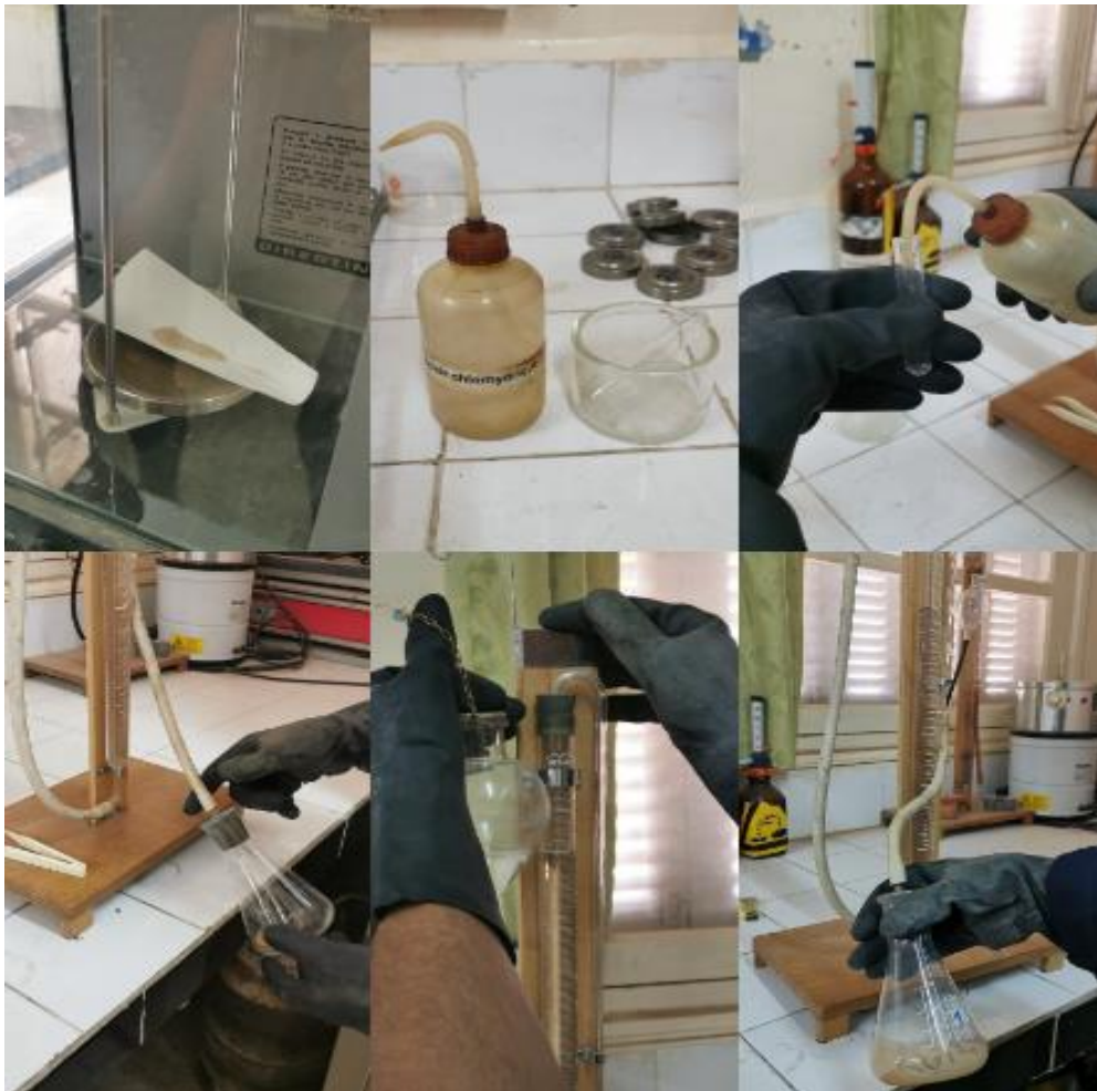
Figure 22 : Détermination de la teneur en carbonates.
