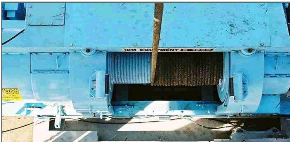
Figure 07 : Le treuil d'un appareil du forage.
