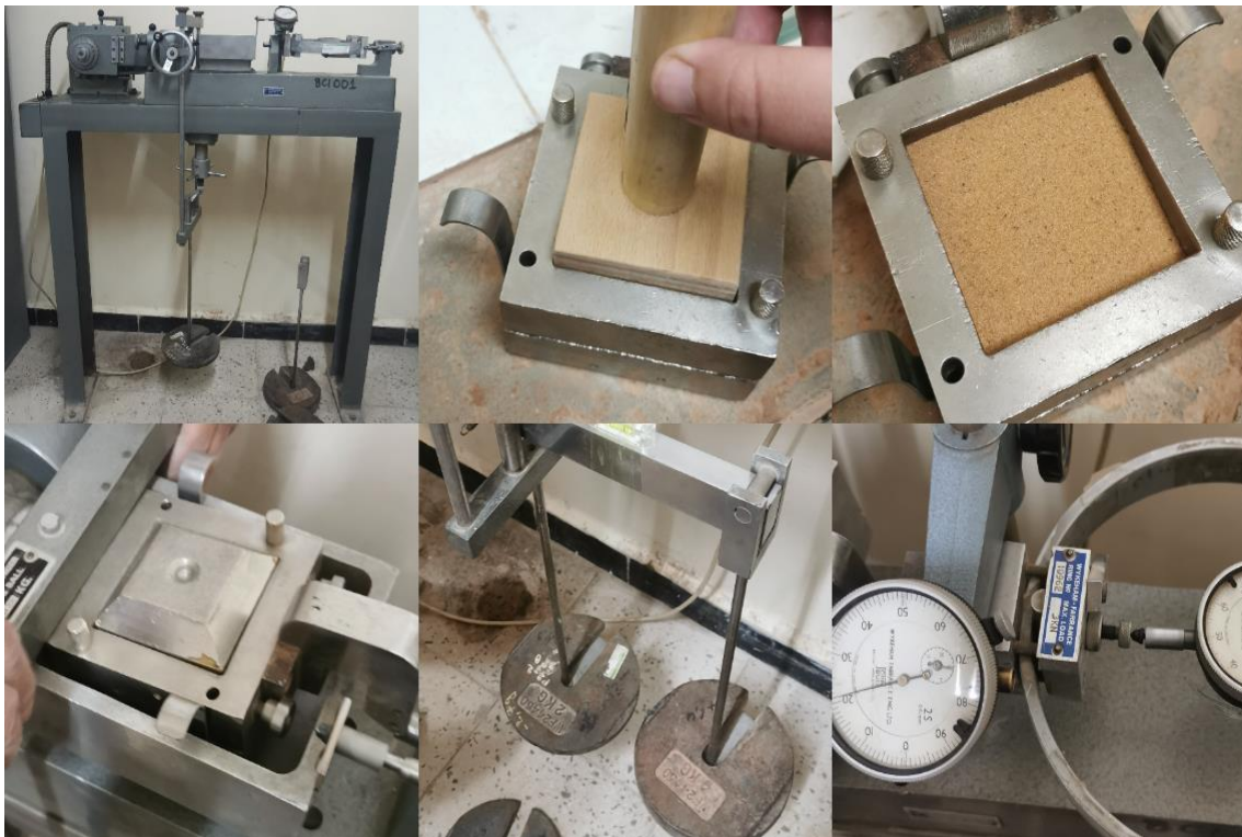
Figure 24 : Essai de cisaillement direct à la boîte.
