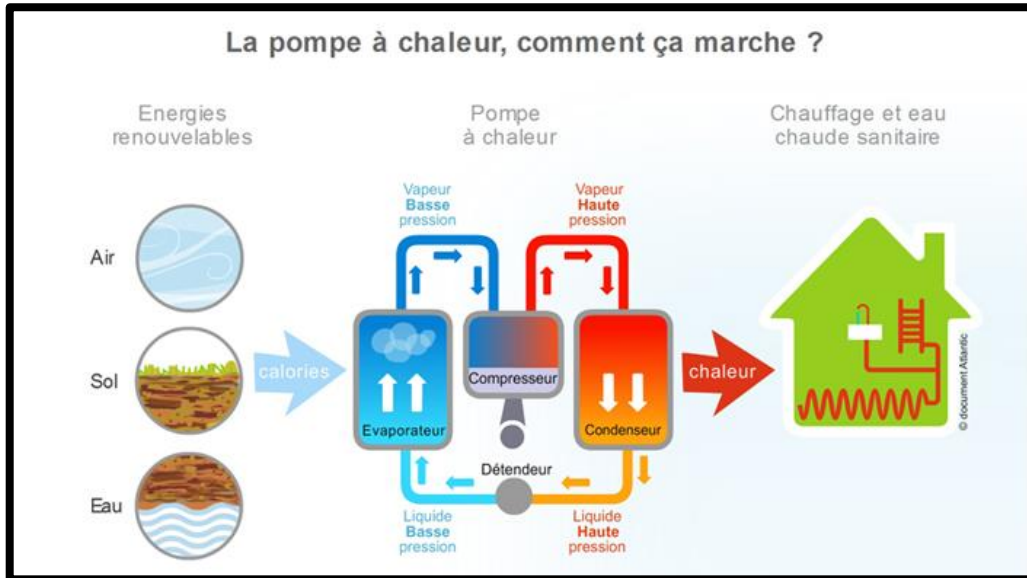
Figure 1.2 : principe fonctionnement de pompe à chaleur
