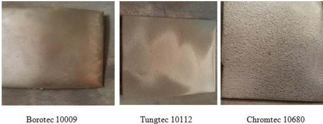
Figure 3.5: Aspects des revêtements déposés à l'aide de la torche SuperJet S
