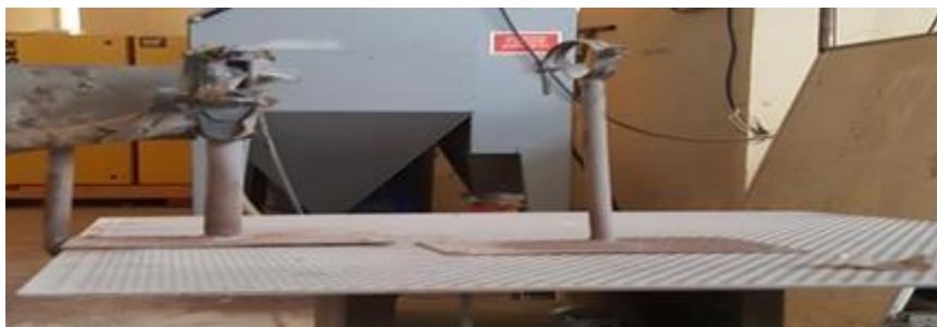
Figure 2.14: Porte échantillon des éprouvettes d'essai d'érosion.
