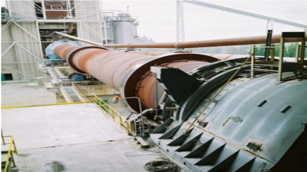
Figure 1.14 :Four rotatif de cimenterie[10].
