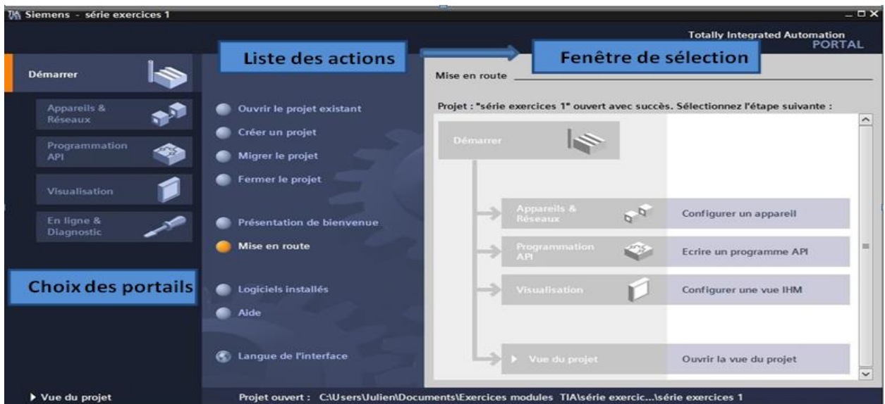
Figure 3.4 : Vue du portail du projet
