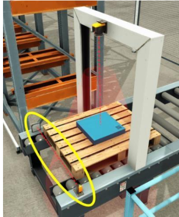
Figure 3.10 Factory io capteur photocellule, convoyeur d'alimentation 1
