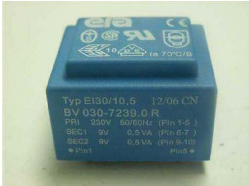
**Figure IV.12 :** Transformateur (230V / 9V) à deux sorties.
