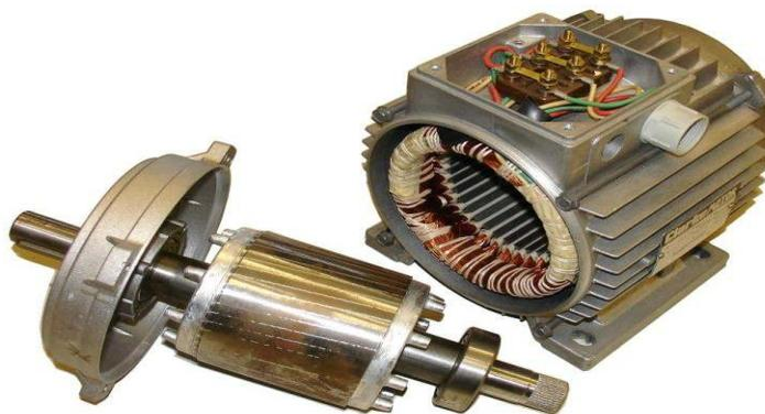
Figure I.1 : photo d'une MAS
