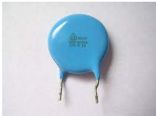
**Figure IV.11 :** Condensateur XY.
