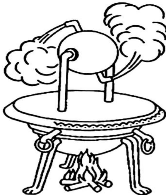
*Figure 2.1.* Turbine à réaction du hero [20].
