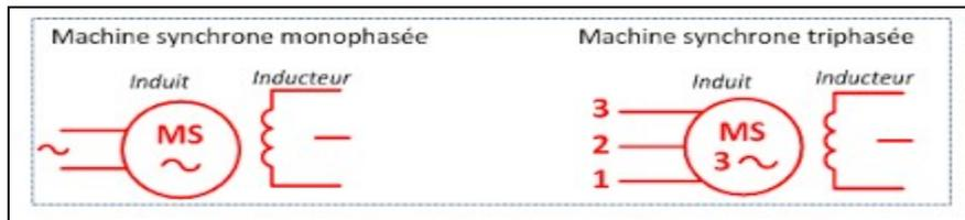
Figure 1. 1 : Symboles électrique d'une machine synchrone [2]
