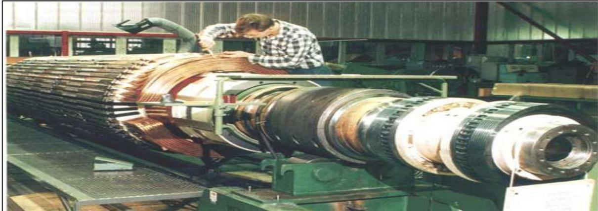
Figure 1. 9 : Rotor d'une machine synchrone à pôle lisse [10]
