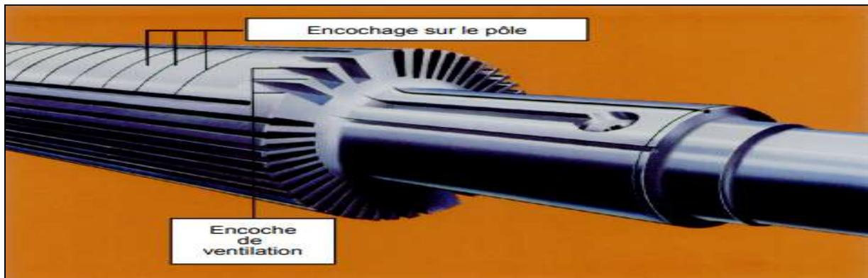
Figure 1. 3: Rotors bobinés à pôles lisses [4]
