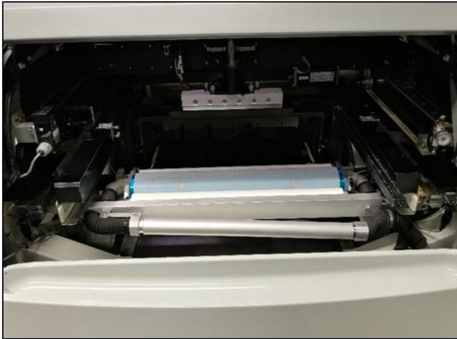
Figure 1.5 Support et raclette d'une machine de sérigraphie
