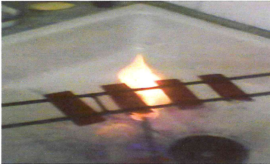
Figure 8 : chauffage des lames par une flamme.
